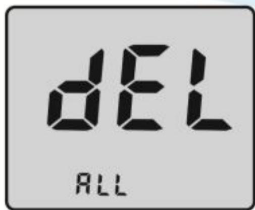
برای پاک کردن کلیه نتایج تستها دکمه ▲ یا ▼ را با هم برای مدت ۳ ثانیه نگه دارید هنگامیکه هیچ نتیج تستی روی صفحه نمایش داده نمی‌شود نشانگر deL روی صفحه چشمک می‌زند.
