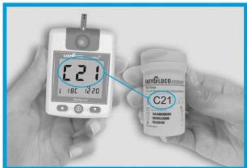
۲- دستگاه کد را بصورت اتوماتیک از روی نوار تشخیص می دهد این روش بسیار راحتی می باشد که هیچگاه در ورود کد نوار به دستگاه اشتباهی پیش نخواهد آمد.
